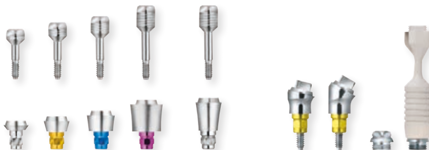
Платформы абатмента MP с цветовой кодировкой (D 3,4–4,5) и винты MP. Количество бороздок на головке винта обозначает высоту десны соответствующей платформы абатмента.
